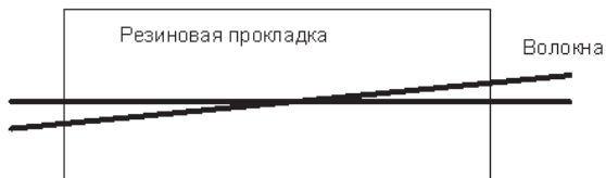
Рис. 4. Схема расположения волокон на резиновых прокладках
