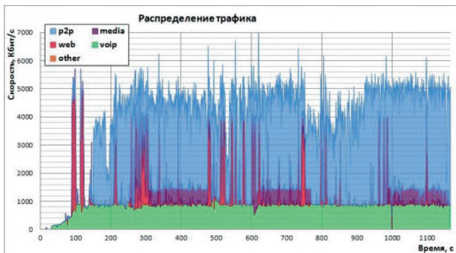
Рис. 3. Распределение трафика на внешнем канале связи с применением алгоритма управления трафиком
