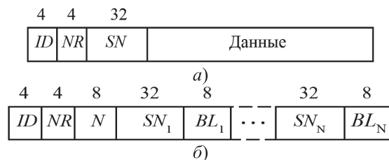
Рис. 3. Форматы сообщений AL-ARQ: а) для передачи данных; б) для отправки отрицательных квитанций запроса повторной передачи и сообщений отмены запроса повторной передачи
