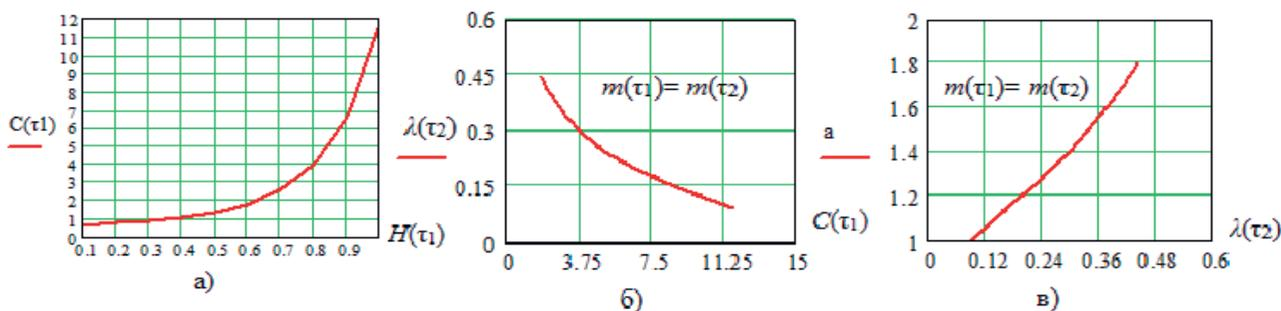
Рис. 1. Графики: а) зависимость коэффициента вариации от показателя Херста входного потока; б) связь между интенсивностью экспоненциального закона и коэффициентом вариации входного потока; в) зависимость показателя формы а закона Парето и интенсивности экспоненциального закона
