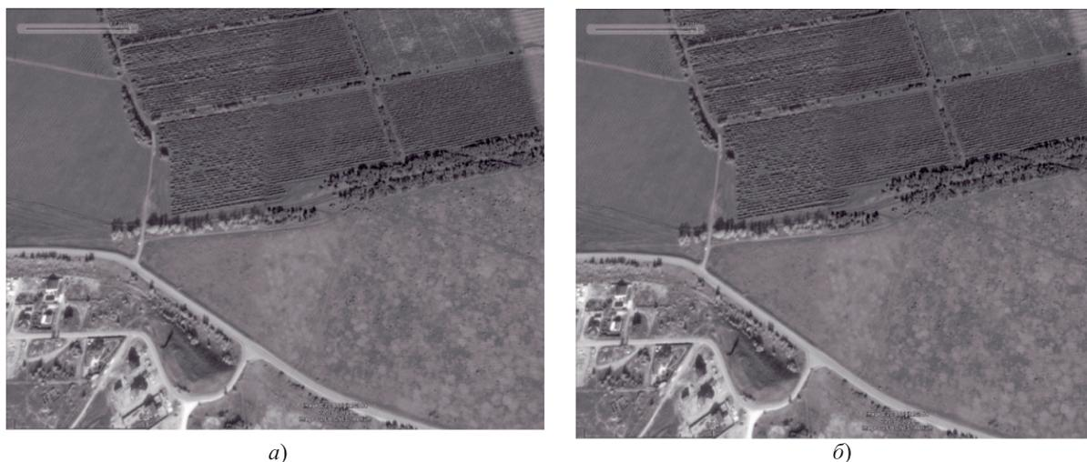
Рис. 5. Изображения лесной посадки: *а)* оптическое; *б)* РЛК при полосе частот 30 МГц, режим излучения ЛЧМ-импульсов, шаг пикселей  $5 \times 5 \text{ м}^2$
