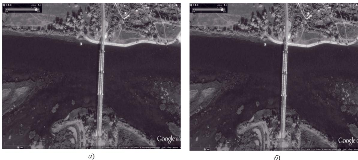
Рис. 4. Изображения железнодорожного моста: *а)* оптическое; *б)* РЛК при полосе частот 30 МГц, режим излучения ЛЧМ-импульсов, шаг пикселей  $5 \times 5 \text{ м}^2$
