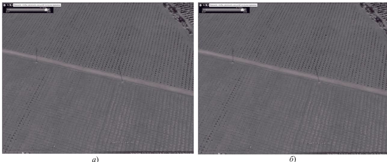
Рис. 6. Изображения ЛЭП: а) оптическое; б) РЛК при полосе частот 30 МГц, режим излучения ЛЧМ-импульсов, шаг пикселей  $5 \times 5 \text{ м}^2$
