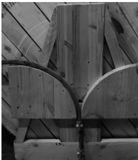
Рисунок 4. Изгиб кабеля на установке на угол 90°
