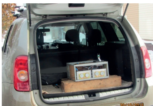
Рисунок 1. Макет мобильной версии защищенной системы радиосвязи для рабочего диапазона частот 2,8 – 3,8 ГГц
