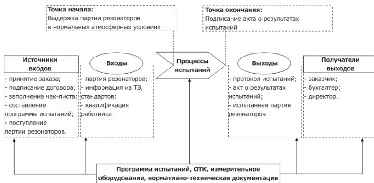
Рисунок 2. Схема процессов испытания кварцевых резонаторов
