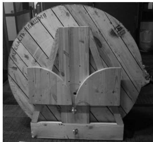
Рисунок 3. Внешний вид установки для испытаний кабелей на изгиб
