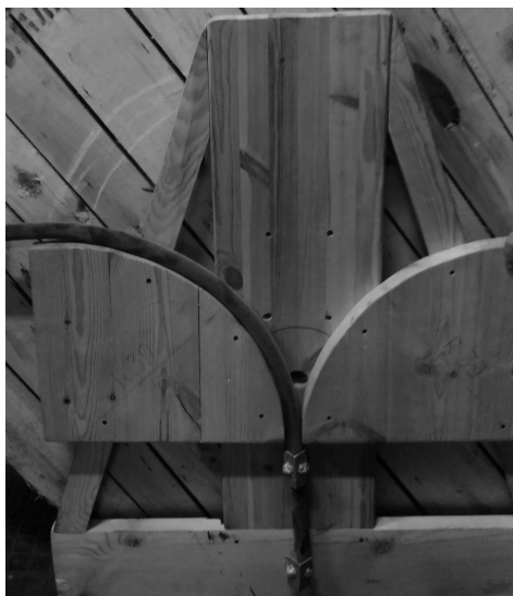
Рисунок 4. Изгиб кабеля на установке на угол 90°
