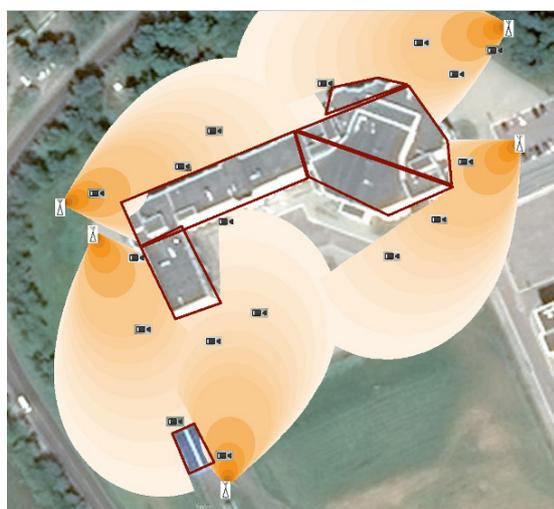
Рисунок 12. Пример размещения ретрансляторов (17 детекторов, 5 ретрансляторов)
