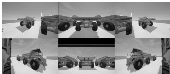
Рисунок 9. Изображения со всех камер системы кругового обзора
