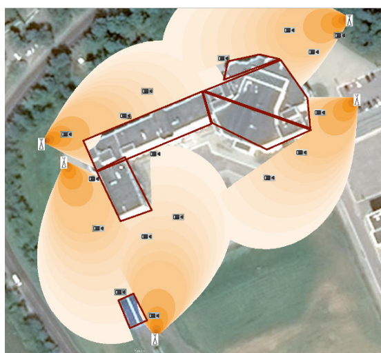
Рисунок 12. Пример размещения ретрансляторов (17 детекторов, 5 ретрансляторов)
