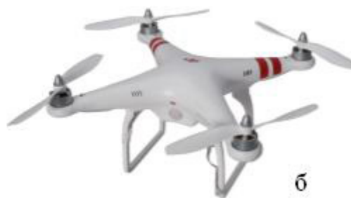
Рисунок 1. БПЛА самолетного типа (а) и мультироторный (б)
