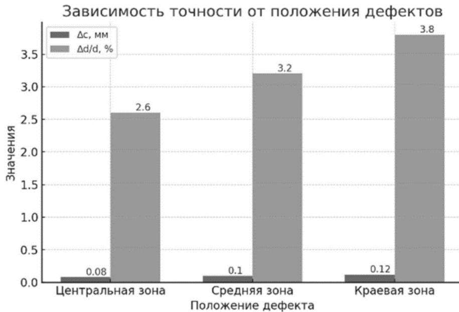
Рисунок 4. Зависимость точности от положения дефектов
