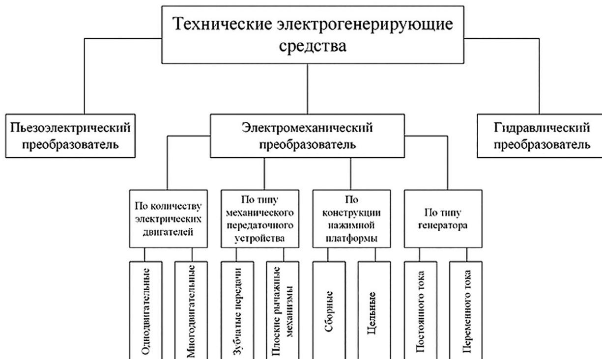
**Рис. 11.** Классификация технических электрогенерирующих средств.
