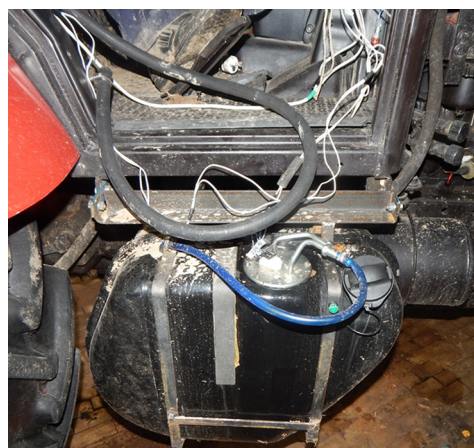
Рис. 4. Система питания трактора для работы на МКБТК
