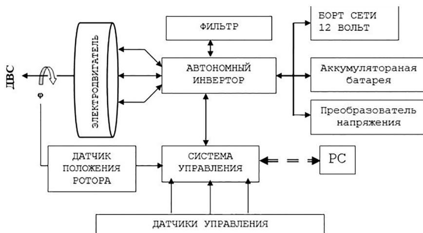
Рис. 2. Блок-схема стартер-генераторной установки
