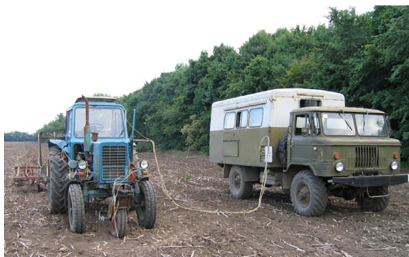
Рис. 4. Общий вид испытываемого трактора-макета в агрегате с прицепным культиватором и измерительным комплексом лаборатории ТЛ-2 на базе автомобиля ГАЗ-66
