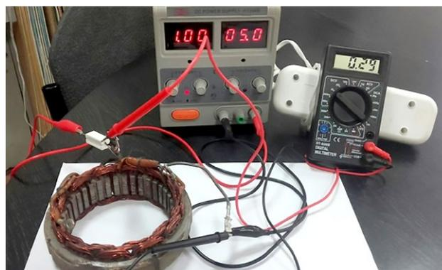
Рис. 9. Экспериментальное исследование обмотки.
