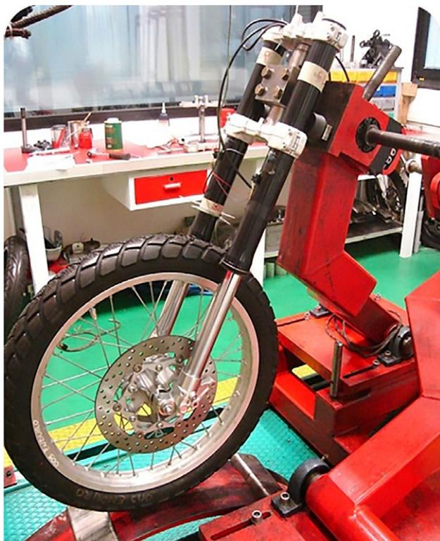
**Рис. 2.** Вилка передней подвески мотоцикла на стенде Cam Drum.
