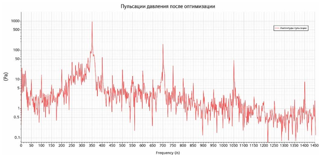
**Рис. 6.** Спектр пульсаций давления после оптимизации.
