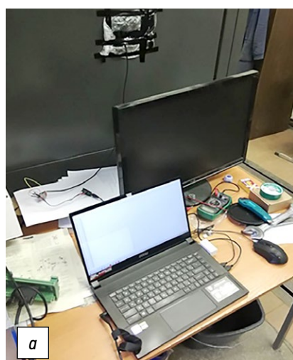
Рис. 8. Экспериментальная установка для определения тепловой постоянной времени: а — датчик температуры и ЭВМ; б — термокамера; с — датчик температуры после нагрева.
