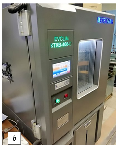
Рис. 8. Экспериментальная установка для определения тепловой постоянной времени: а — датчик температуры и ЭВМ; б — термокамера; с — датчик температуры после нагрева.
