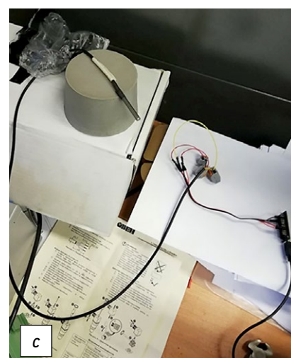
Рис. 8. Экспериментальная установка для определения тепловой постоянной времени: а — датчик температуры и ЭВМ; б — термокамера; с — датчик температуры после нагрева.
