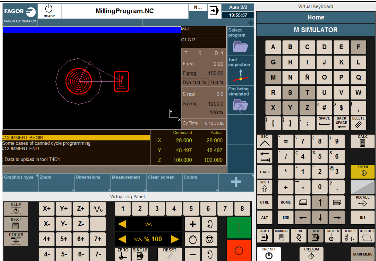
Рис. 6. 2D-визуализация в системе ЧПУ FAGOR.
