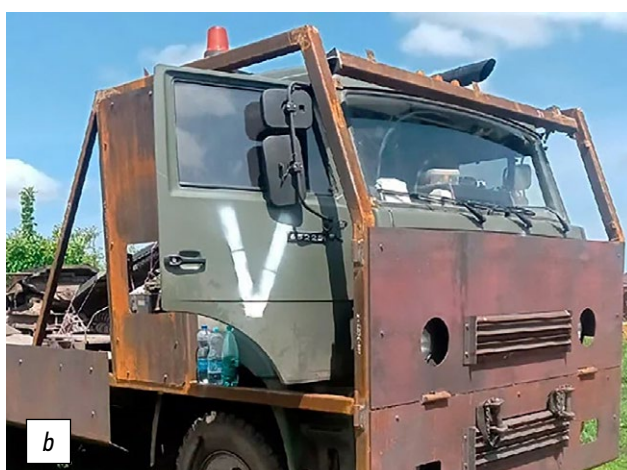
Рис. 4. Бронезащита автомобиля КамАЗ: a — КамАЗ-63501 с дополнительной бронезащитой лобовой проекции кабины; b — пример сварного каркаса и обшивки стальными листами.
