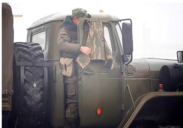
Рис. 3. Крепление бронезилета на двери «Урала». Fig. 3. The body armor mounting at the door of the Ural truck.
