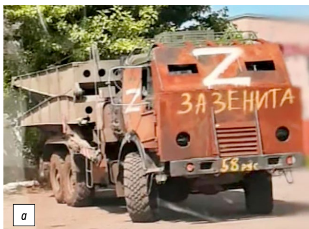
Рис. 4. Бронезащита автомобиля КамАЗ: a — КамАЗ-63501 с дополнительной бронезащитой лобовой проекции кабины; b — пример сварного каркаса и обшивки стальными листами.
