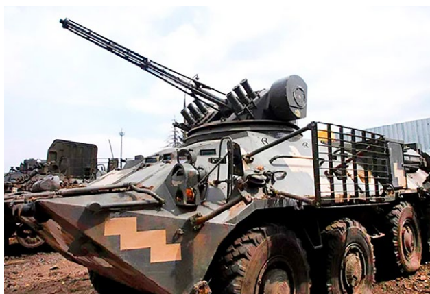
Рис. 5. Трофейный БТР-3 ВСУ с антикумулятивной решёткой, прикрывающей зону размещения экипажа.
