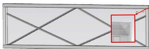
Рис. 8. Плита, сваренная из экструдированного профиля 6066 \sigma_t = 360 МПа.
