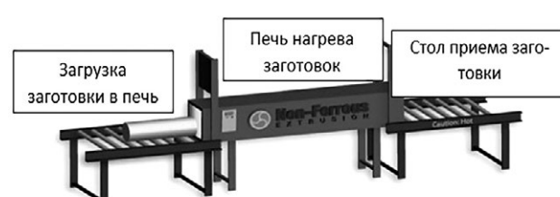
Рис. 4. Разогрев заготовки перед её экструзией. Fig. 4. Heating of a blank before the extrusion of it.
