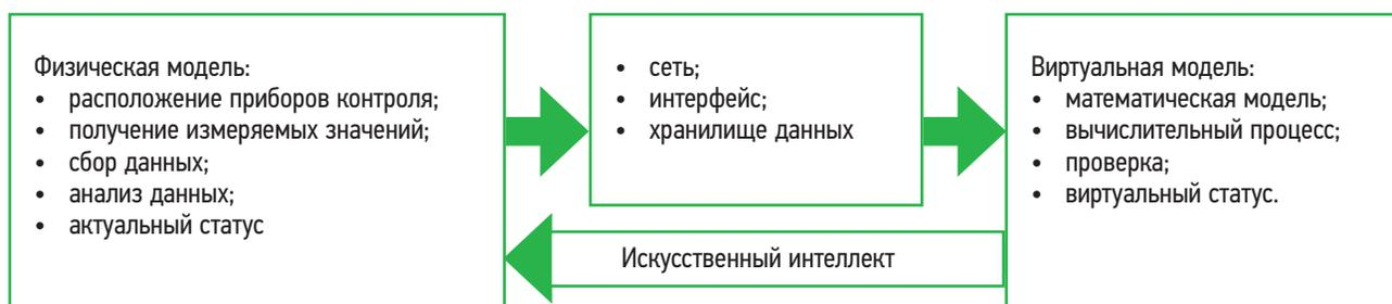
**Рис. 2.** Концепция цифрового двойника пневмогидравлического привода.
