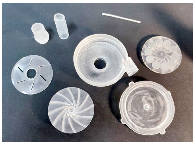
Рис. 2. Детали насоса, полученные фрезерованием. Fig. 2. The milled pump details.
