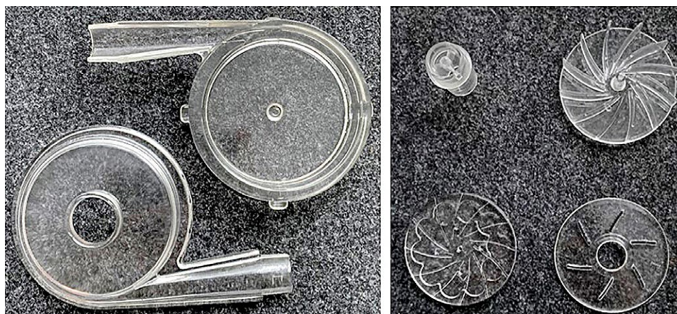
Рис. 3. Детали насоса, изготовленные литьём в силиконовые формы. Fig. 3. The pump details, manufactured by casting in silicone molds.
