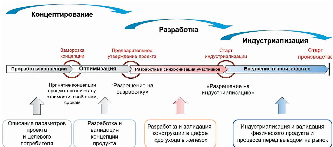
**Рис. 1.** Концепция системы создания автомобиля.
