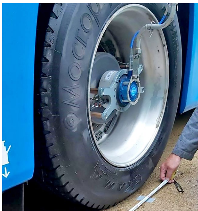
Рис. 3. Тензометрические измерительные колёса Kistler RoaDyn. Fig. 3. The Kistler RoaDyn wheel force transducers.
