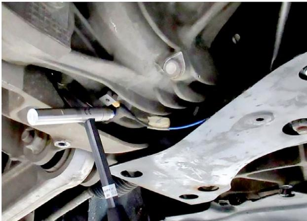
**Рис. 5.** Удар модальным молотком по корпусу передней главной передачи.
