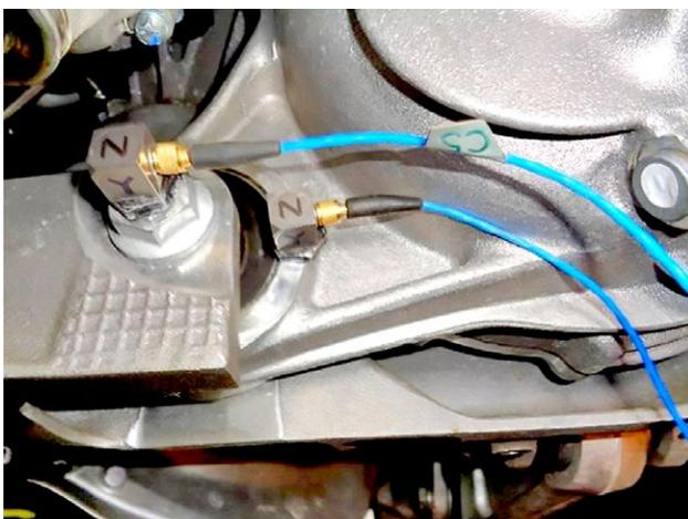
**Рис. 6.** Датчики ускорений, установленные на опорах передней главной передачи.
