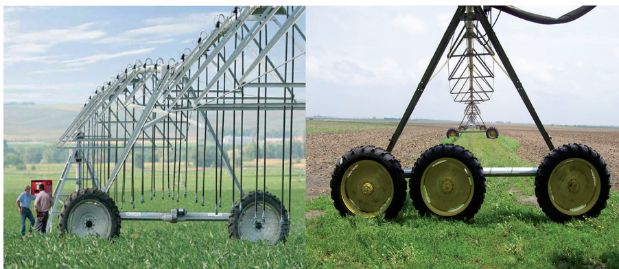
Рис. 1. Двухколесные и трехколесные опорные тележки дождевальных машин
