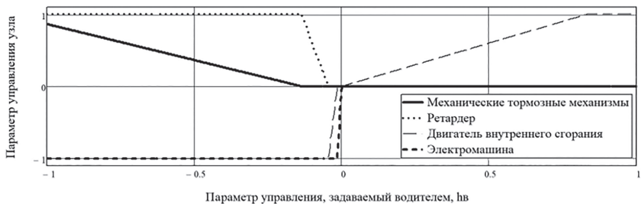
Рис. 11. Срез поверхностей отклика системы распределения тяговых/тормозных моментов (температура ОЖ находится в норме, накопитель энергии полностью разряжен)
