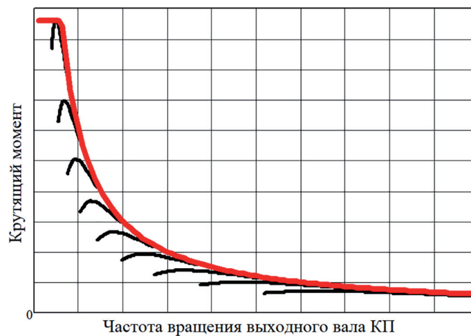
Рис. 5. Совместная механическая характеристика двигателя и коробки передач (в тяговом режиме)
