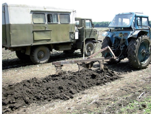
Рис. 1. Общий вид испытываемого трактора-макета в агрегате с навесным плугом ПЛН-3-35 и измерительным комплексом лаборатории ТЛ-2 на базе автомобиля ГАЗ-66
