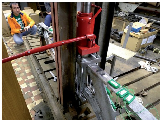
Рис. 13. Балансир с тензорезисторами, регистрирующей аппаратурой и нагрузочным устройством
