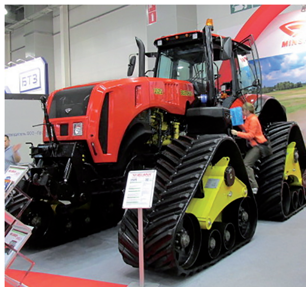
Рис. 2. Трактор Belarus 3525, оборудованный гусеничными модулями
