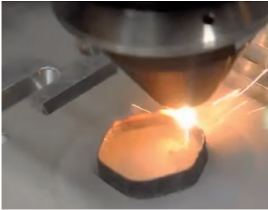
Рис. 7. Изготовление металлической детали методом трехмерной печати
