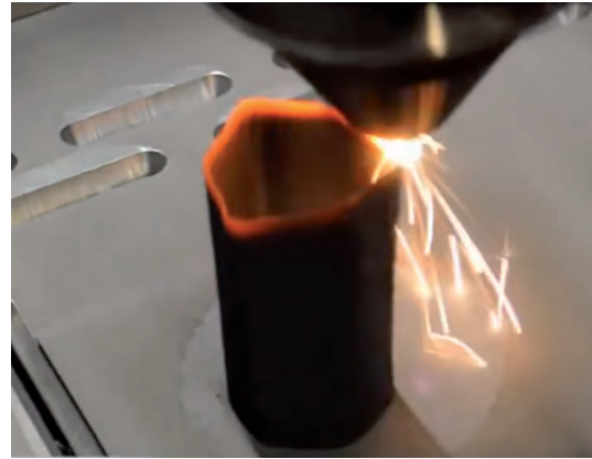
Рис. 7. Изготовление металлической детали методом трехмерной печати
