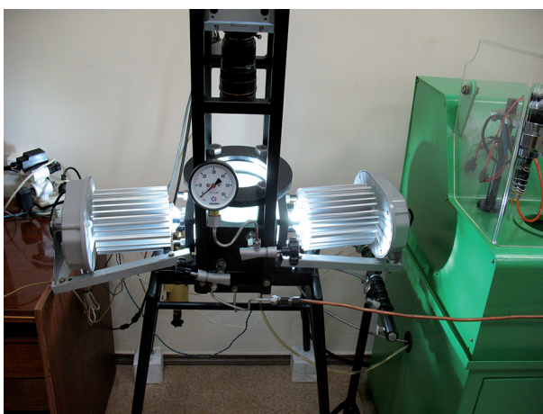
Рис. 2. Камера постоянного объема со светодиодными прожекторами
