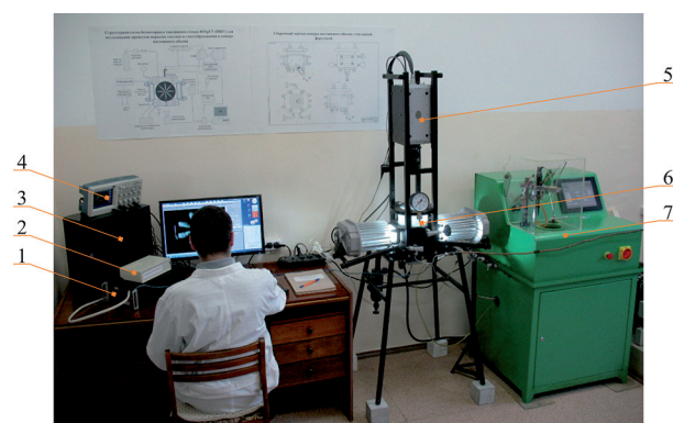
Рис. 3. УНУ «Впрыск» для исследования процессов впрыска и смесеобразования в камере постоянного объема с высокоскоростной видеосъемкой:
