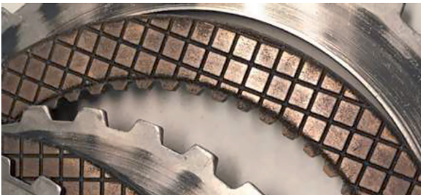
Рис. 10. Внешний вид поверхностей трения диска фрикционного с материалом ФМ-15 после 5000 циклов включения
