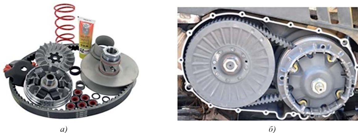
Рис. 2. Детали (а) и клиноременный вариатор в сборе (б) для легких транспортных средств
