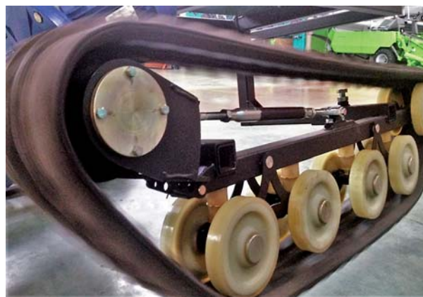
Рис. 4. Работа вывешенного борта ходовой системы СГО
