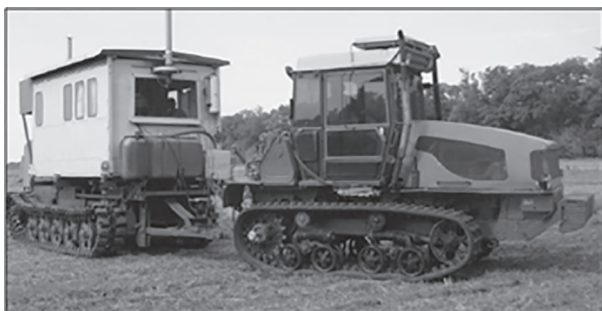
Рис. 2. Трактор ВТ-150 на РАГ в процессе тяговых испытаний
