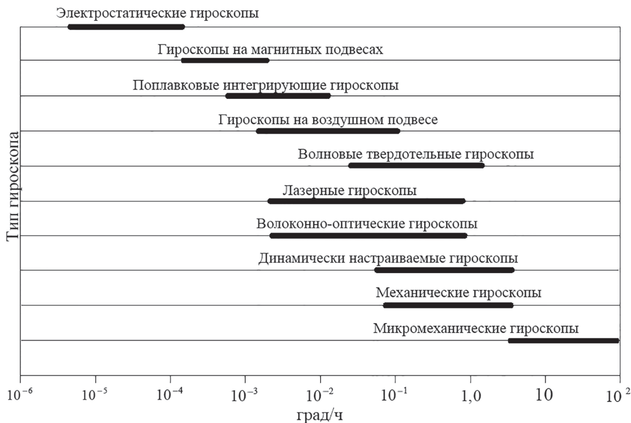
Рис. 1. Типичная нестабильность смещения нуля (дрейфа) гироскопов разных типов
