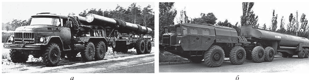
Рис. 5. Активные автопоезда с гидрообъемным приводом полуприцепа: а – ЗИЛ-137; б – МАЗ-7410-9988
