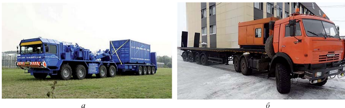
Рис. 7. Активные автопоезда с гидрообъемным приводом полуприцепа типа «гидромотор-колесо»: а – FAUN SLT; б – полуприцеп «НАМИ-Сервис» с тягачом КамАЗ-44108
