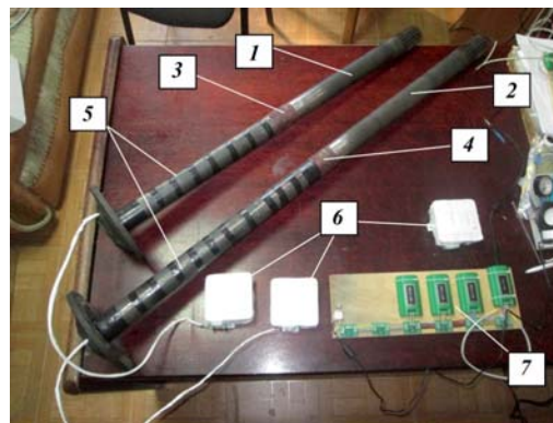
Рис. 3. Полуоси с тензоизмерительной аппаратурой:
