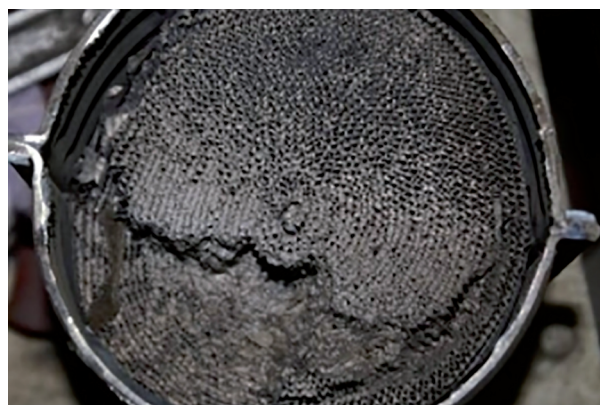
Рис. 4. Внешний вид катализатора с оплавленными ячейками
