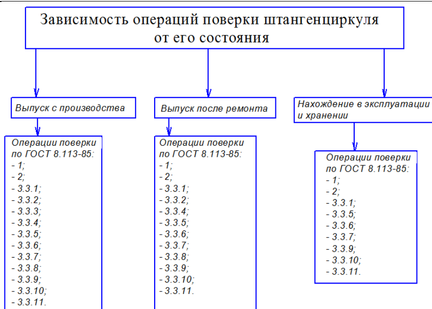
Рисунок 1. Зависимость этапов поверки от состояния штангенциркуля
