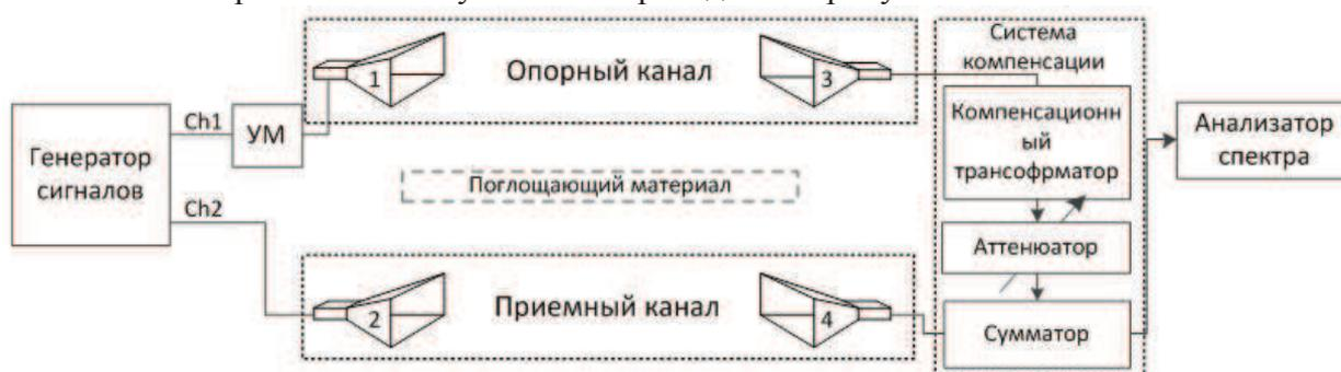
Рисунок 3. Схема экспериментальной установки
