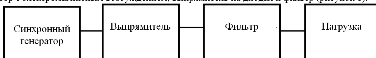
Рисунок 1. Блок-схема автомобильной генераторной установки.
