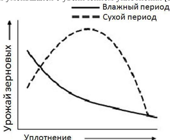
Рисунок 1. Зависимость урожая зерновых от уплотнения почвы в сухой и влажный периоды
