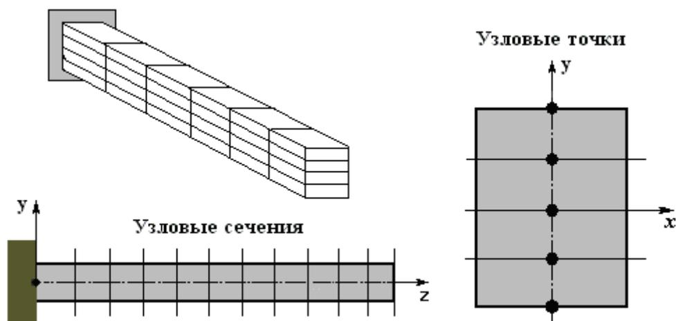
Рисунок 2. Геометрическая модель бруса
