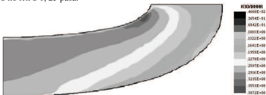
Рисунок 2. Изолинии чисел Маха скорости потока в диффузоре с оптимизированной геометрией (меридиональное сечение)
